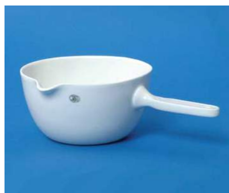
Odpařovací miska s držadlem Casserole with porcelain handle Kasserolle mit Porzellanstiel Cazo con mango de porcelana Кастрюля с держателем
