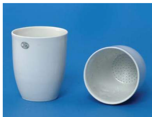
Kelímek Goochův Gooch crucible Gooch Filterstiegel Crisol Gooch de filtrar Тигель Гооха
