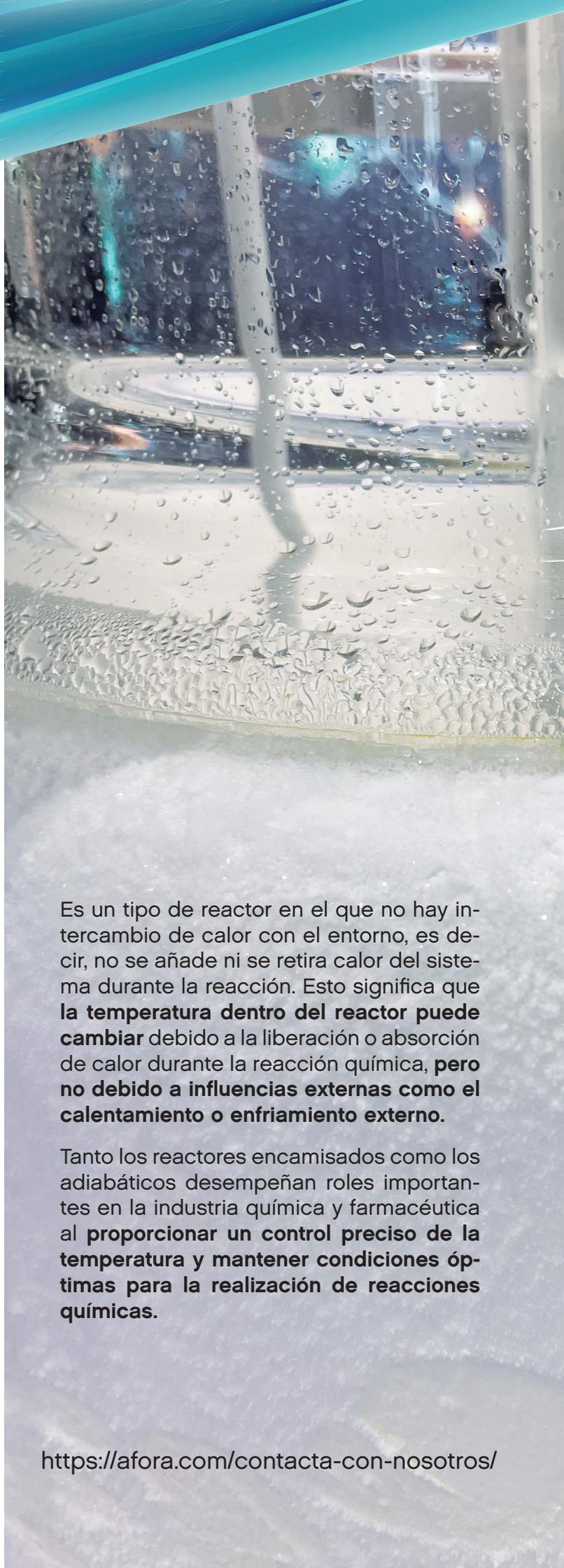
Es un tipo de reactor en el que no hay intercambio de calor con el entorno, es decir, no se añade ni se retira calor del sistema durante la reacción. Esto significa que **la temperatura dentro del reactor puede cambiar** debido a la liberación o absorción de calor durante la reacción química, **pero no debido a influencias externas como el calentamiento o enfriamiento externo.**
