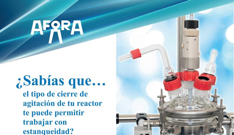
El cierre de agitación desempeña un papel crucial al centrar y alinear la varilla de agitación en el cuerpo del reactor. Esta pieza esencial se coloca en el puerto central de la tapa de vidrio y está disponible en una variedad de modelos adaptados a diferentes tipos de ensayos.
