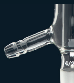
Olivas rectas y asimétricas (en lados distintos del refrigerante)
